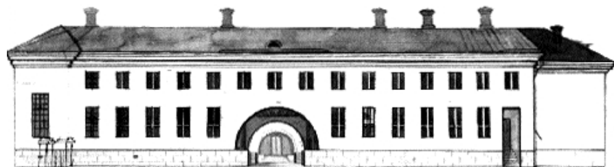
Orangeribygnaden har sin huvudentré från norr. Ett portvalv är utformat som en halvcirkel i fasadmuren mot norr och repeteras mot borggården. Bågformen går under beteckningen 'den sjunkna bågen' och har sitt ursprung i de antika triumfbågarna på Forum Romanum i Rom. Under 1700-talet var triumfbågarna till två tredjedelar gömda under jorden. Den smala passagen försvann år 1856. Lavering av norra flygelns norra fasad före år 1835.
